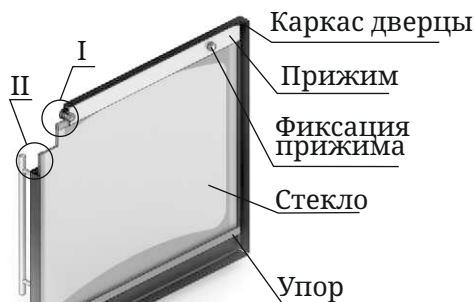
Рисунок 15. Ремонт светопрозрачного экрана дверцы модификации «Витра»
